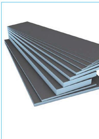
Avec le panneau de construction wedi, les salles de bains peuvent être efficacement et facilement isolées de l'intérieur. Le panneau d'isolation thermique XPS Core est étanche et fournit une base optimale pour les carreaux et autres revêtements de sol, de mur et de plafond. Même avec un panneau de construction de 20 mm d'épaisseur, la perte de chaleur peut être réduite de plus de moitié, selon le mur extérieur.
